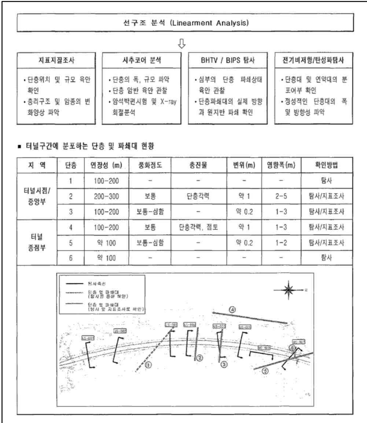
<표 2.1.7> 터널구간의 단층 및 파쇄대(2008.12) 현황
